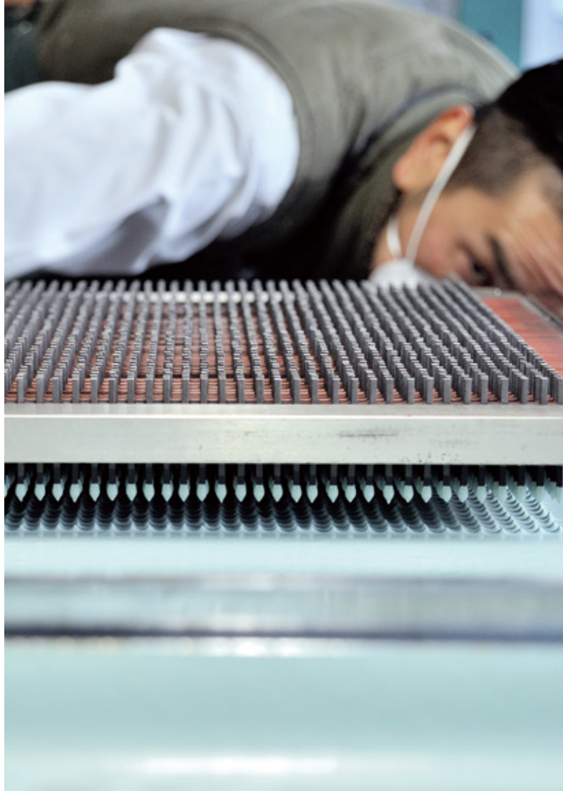
写真左、頭薬を作る練り釜。一度に約2万本分の頭薬を練ることができる。その日の天気や温度で水を入れるタイミングを調節していく。写真右、頭薬をお香の頭に塗布していく。
