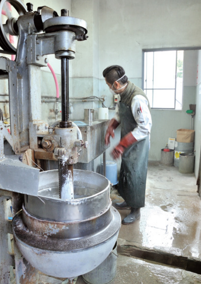
写真左、頭薬を作る練り釜。一度に約2万本分の頭薬を練ることができる。その日の天気や温度で水を入れるタイミングを調節していく。写真右、頭薬をお香の頭に塗布していく。
