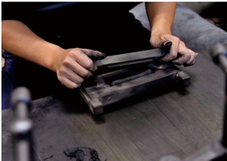
(写真、中央) 小玉を再び空気が入らないようによく揉み込み、(写真、右下) きれいに練れたら木型に入れる。後はプレスにかけて、30分～60分前後経ったら型出しする
