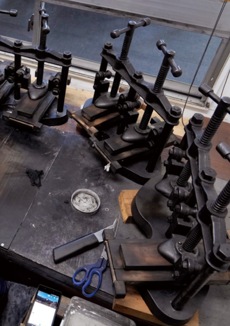
(写真、中央) 小玉を再び空気が入らないようによく揉み込み、(写真、右下) きれいに練れたら木型に入れる。後はプレスにかけて、30分～60分前後経ったら型出しする
