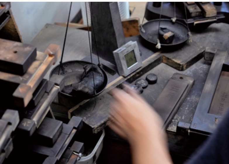
煤と膠を機械で混ぜ合わせ練った後、型入れ職人が足や手を使って仕上げの混和。(写真、左下) 練りが整ったところで型に合わせて計量して、小玉にする
