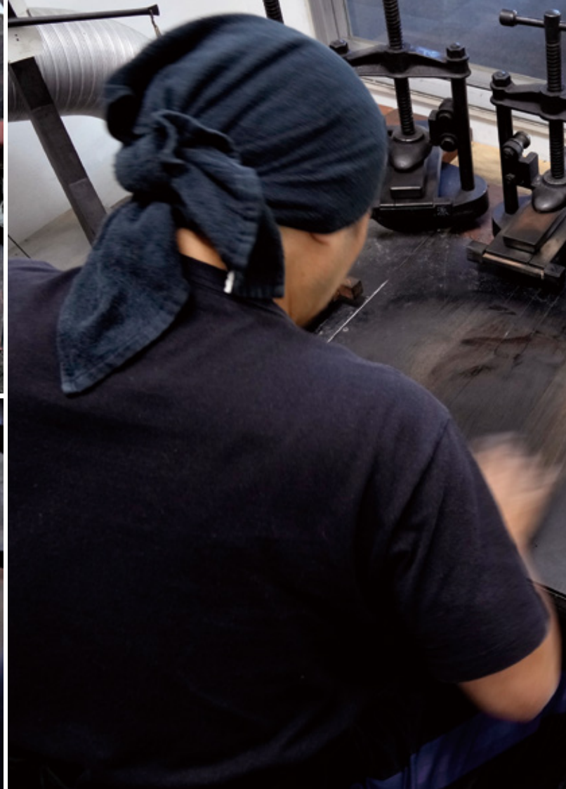
煤と膠を機械で混ぜ合わせ練った後、型入れ職人が足や手を使って仕上げの混和。(写真、左下) 練りが整ったところで型に合わせて計量して、小玉にする
